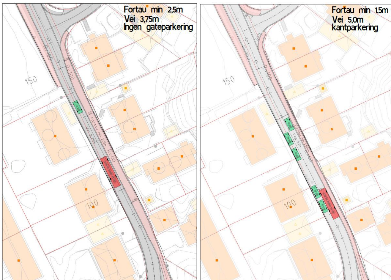
Figur 37. Variant 1 med 2,5 meters fortau (til venstre) og variant 2 med 1,5 meters fortau (til høyre).
