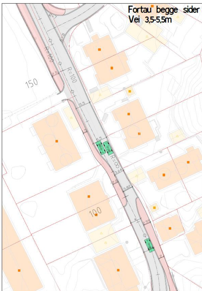
Figur 38. Variant 3, med stedstilpasset fortaus- og veibredde, med opprettholdelse av noe mulighet for stans/kantparkering for beboere.
