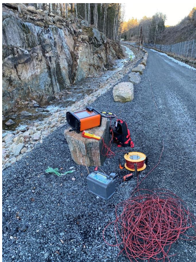
Figur 3: Seismograf og utstyr for refraksjonsseismikk
