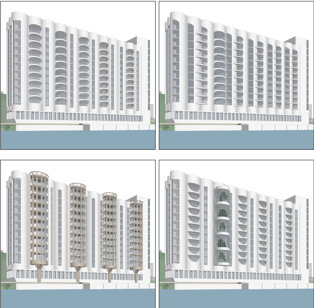
Figur 8 Fire ulike løsninger for balkonger/vinterhager. Øverst til venstre inntrukne balkonger, øverste til høyre utenpåhengte balkonger. Nederst ulike "vinterhage"-varianter.
