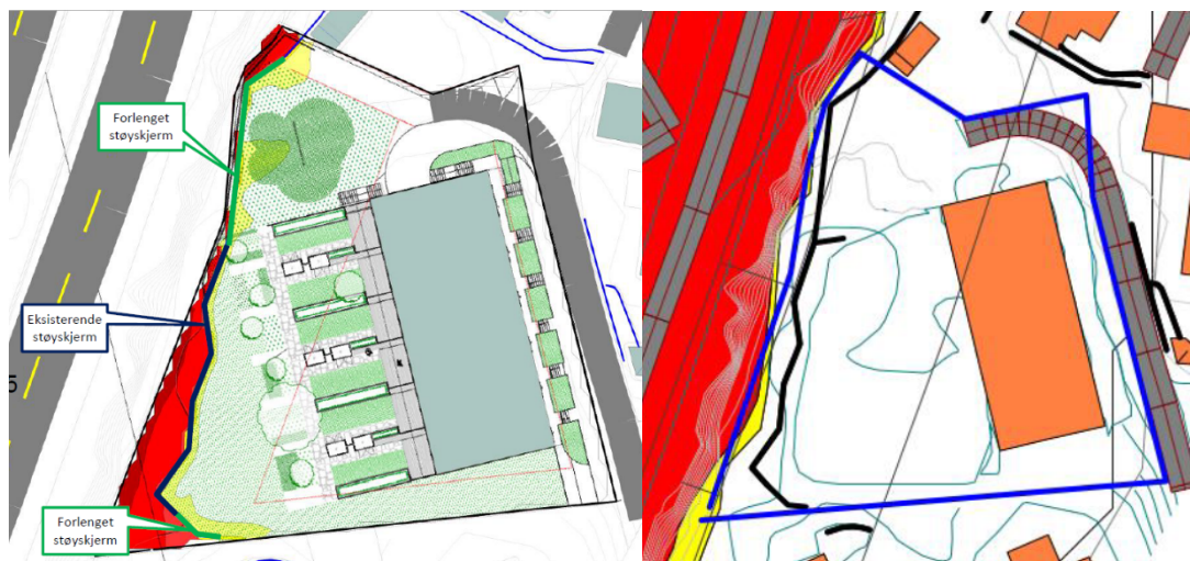
9 Støysituasjon etter tiltak målt 1,5 m over bakken.
