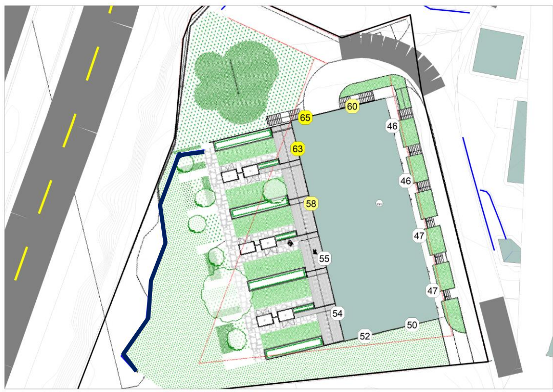
Figur 8 – Støynivå L_{den} ved fasade uten tiltak. Høyeste nivå er vist uavhengig av etasje. Overskridelse av L_{den} = 55 dB er vist i gult og gjelder kun for øverste etg.
