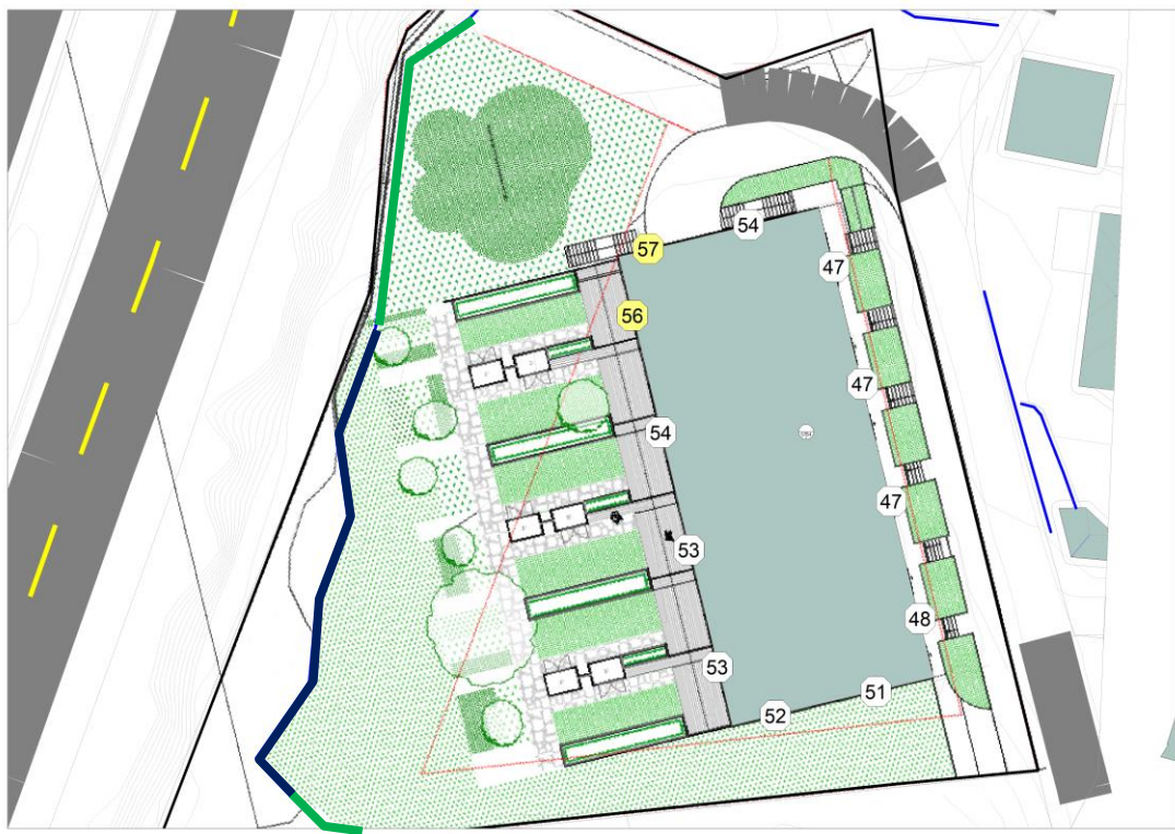
Figur 9 - Støynivå L_{den} ved fasade med forlenget støyskjerm mot nord og sør. Høyeste nivå er vist uavhengig av etasje. Overskridelse av L_{den} = 55 dB er vist i gult og gjelder kun for øverste etg.
