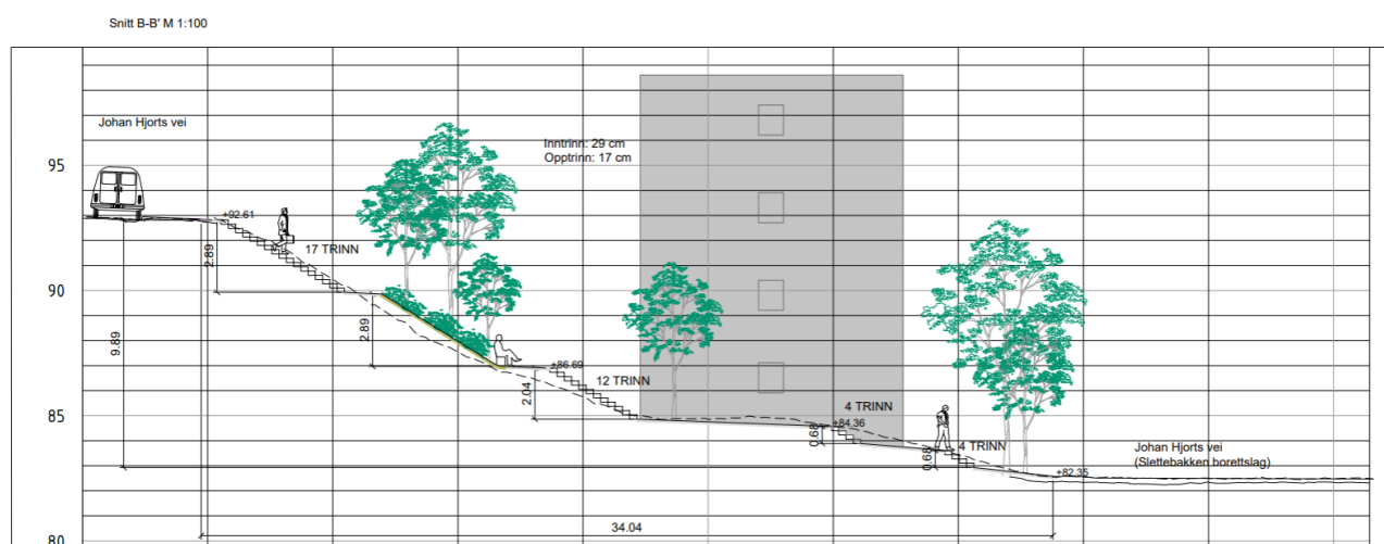
Snitt av anbefalt løsning, forbindelse mellom Johan Hjorts vei og Vilhelm Bjerknes vei (Utsnitt av tegningsnummer O002)
