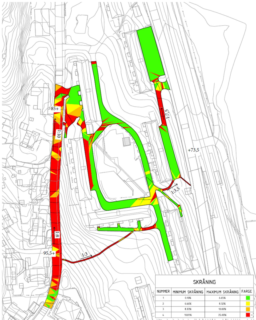
Figur 5 Stigningsanalyse av eksisterende gangnett ved Slettebakken borettslag..
