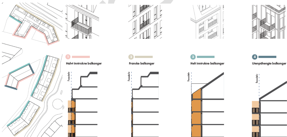
Figur 40. Prinsipp for plassering og utforming av balkonger, hentet fra formingsveileder.
