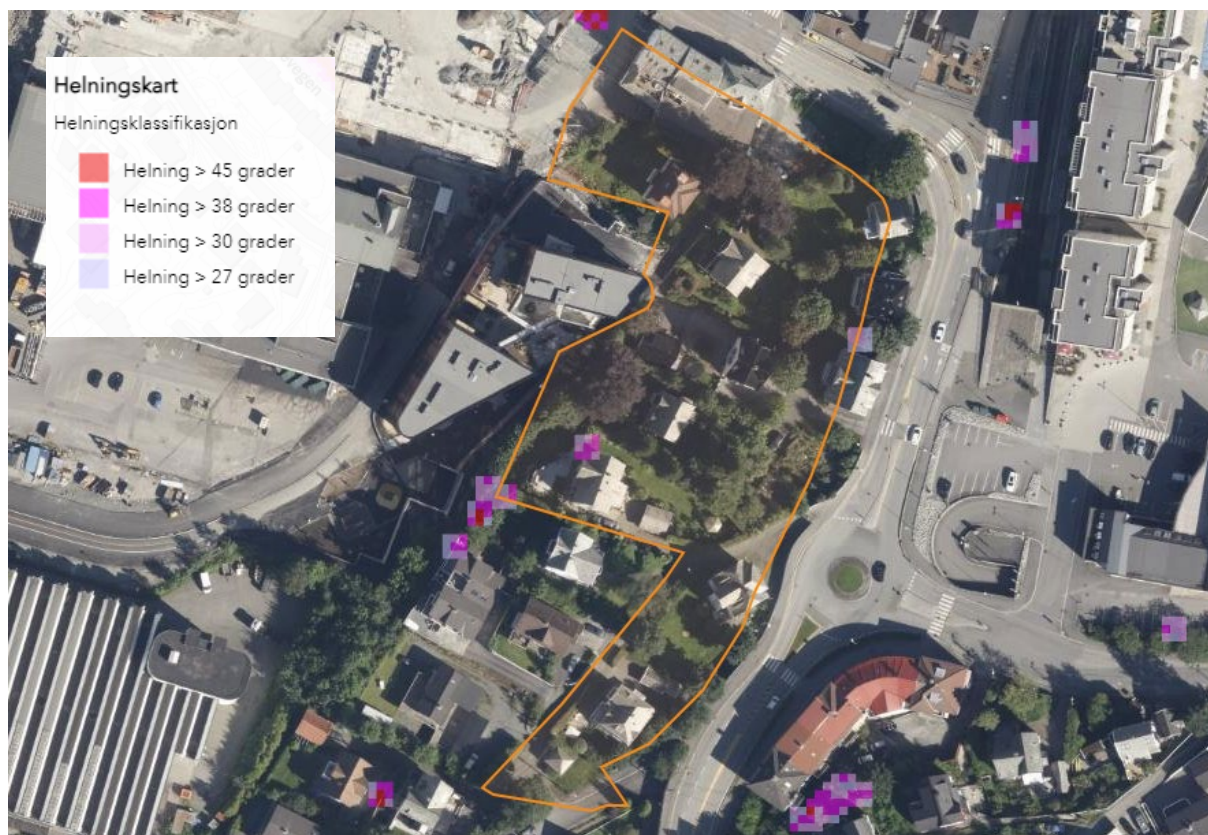
Figur 5-6: Helningskart på ortofoto viser bratt terreng ved nåværende situasjon (bergenskart.no 02.04.24)
