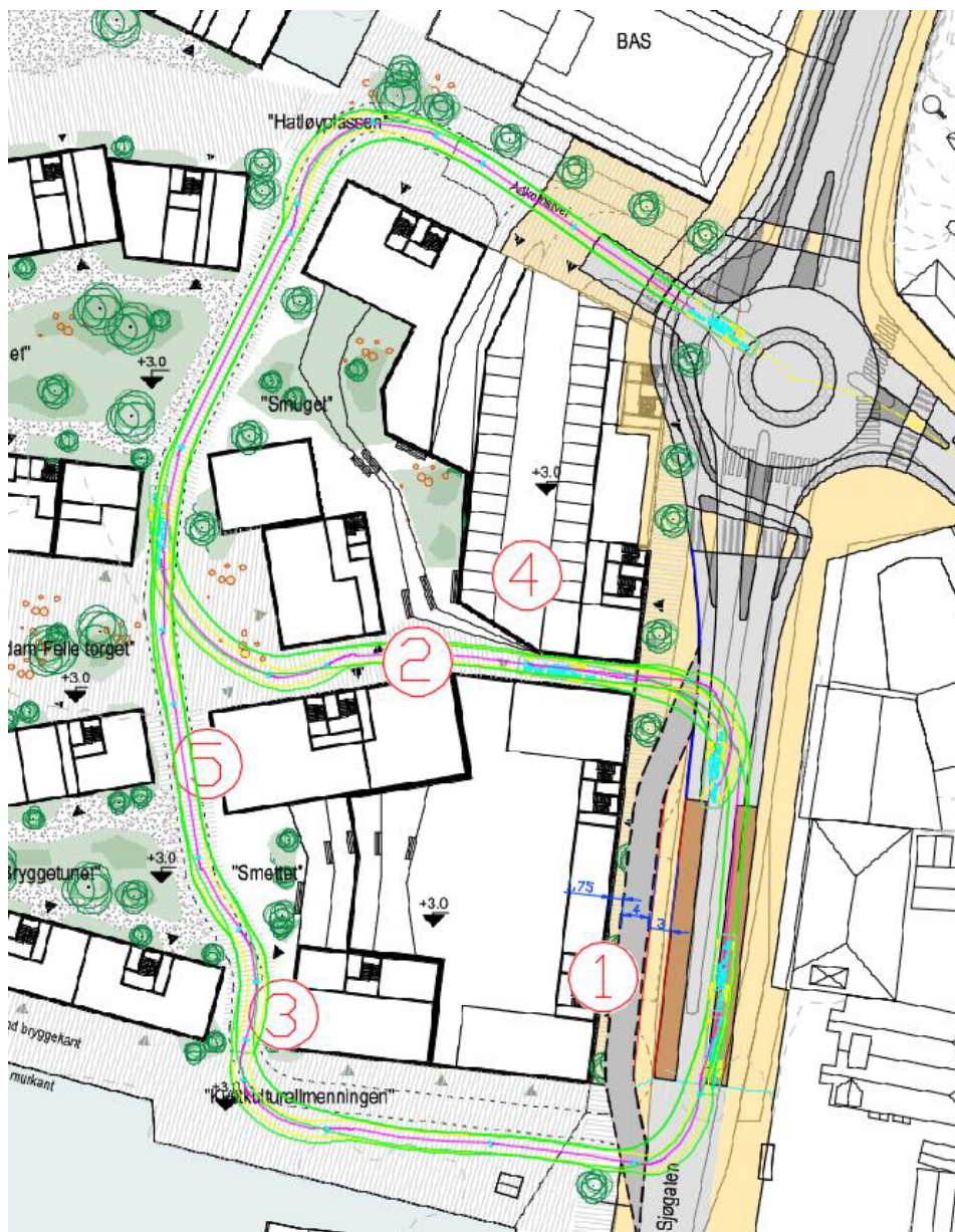
Figur 5-71: Illustrasjon som viser fem alternative lokaliseringer for varelevering. Springer for lastebil (12m) med grønn linje viser tilkomst fra nord i rundkjøringen, og ut i Sjøgaten via Kystkulturellmenningen. Doble kantstopp for buss er vist med brune felter i Sjøgaten. Disse er redusert til enkle kantsopp i endelig plan.
