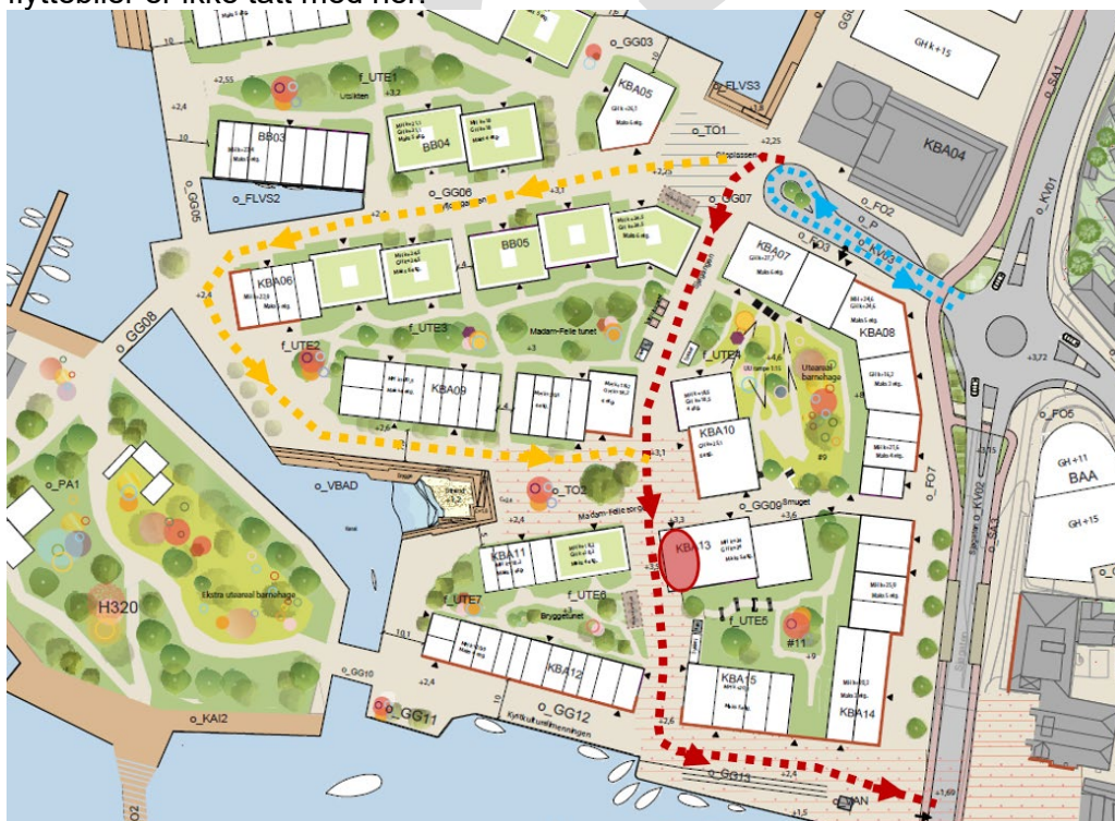
Figur 5-75: Illustrasjonen viser tillatt kjøremønster for henholdsvis besøkende/drop-off (blå), varelevering til barnehage, dagligvare og annen næring (rød) nyttetraffikk/service o.l. (gul). Vareleveringshub er markert med rød sirkel.
