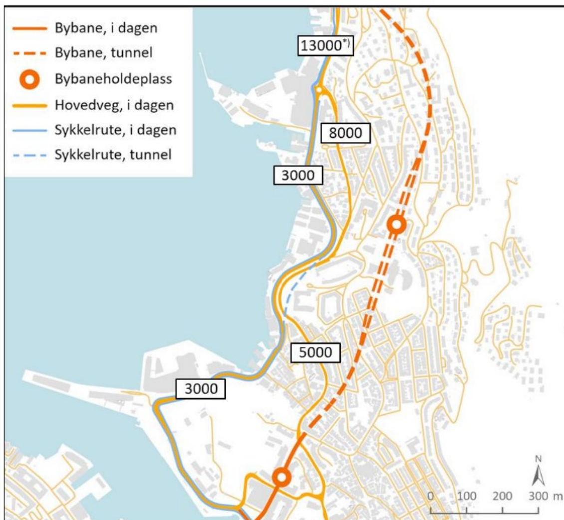
Figur 5-84: Illustrasjon hentet fra DSS – Hovedsykkelrute Festningskaiaen – Sandviksveien som viser trafikkprognoser for 2040. *)Trafikk i trafikkfase 2 med stengt for biltrafikk over Torget, vil øke trafikken i Sandviksvegen nord fra 13000 ved åpent over Torget,
