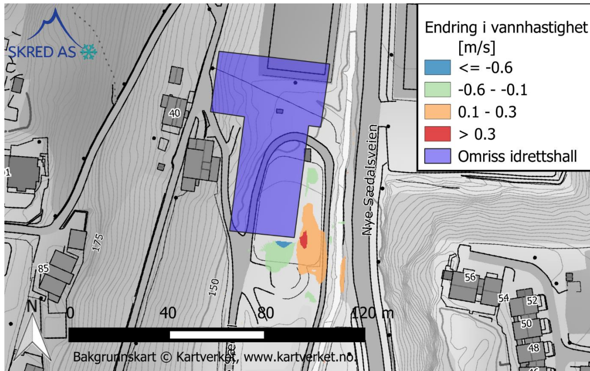
Figur 17: Endring i vannhastighet med og uten idrettshall/terrenginngrep. Verdier innenfor \pm 0,1 m/s vises ikke.
