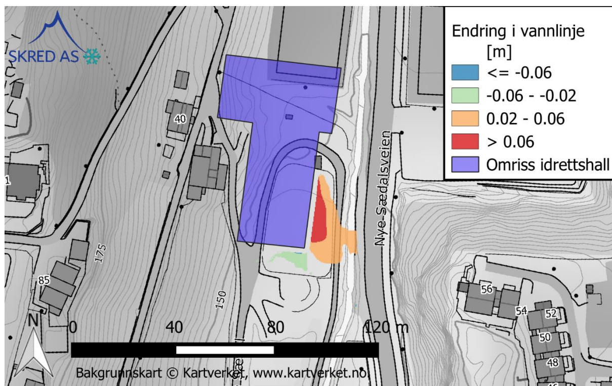
Figur 16: Endring i vannlinje med og uten idrettshall/terrenginngrep. Verdier innenfor \pm 0,02 vises ikke.
