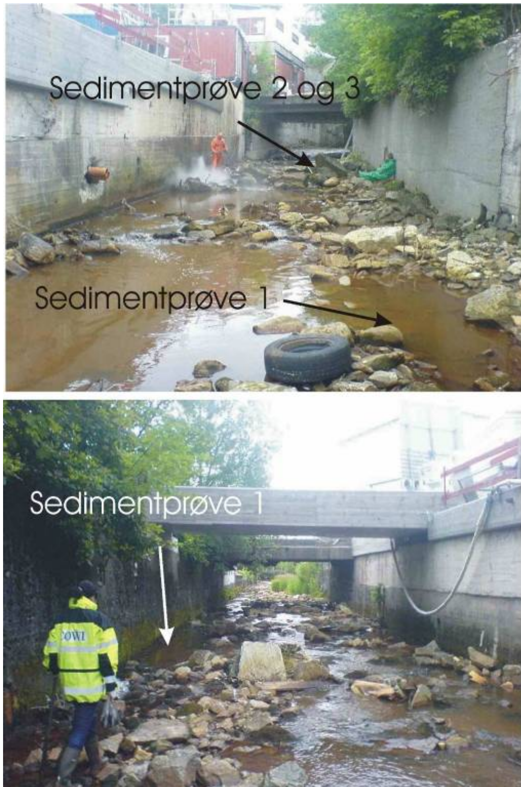
Figur 21. Byggetreprenøren på nordøst-siden av Møllendalselven har trykkspylt større deler av murveggen og muligens også elvebunnen. Sedimentprøve #1 er tatt nedstrøms for denne aktiviteten.
