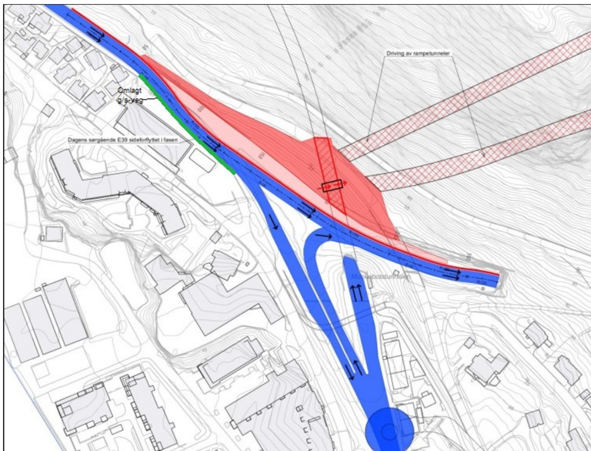
Figur 2. Området i anleggsfasen. E39-trafikken benytter dagens rampe retning sør mens nye rampetunneler sprenges ut. Grønn linje viser omlagt sykkelveg ved Glass Knag.
