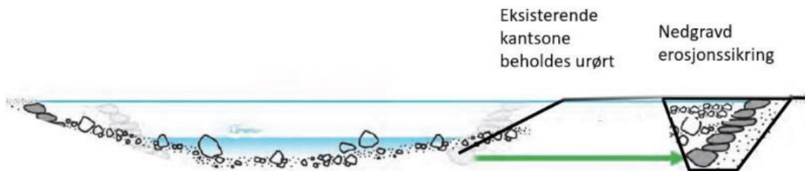
Figur 20: Prinsippskisse av tilbaketrukket erosjonssikring, skissert over figur fra (NORCE, 2018)
