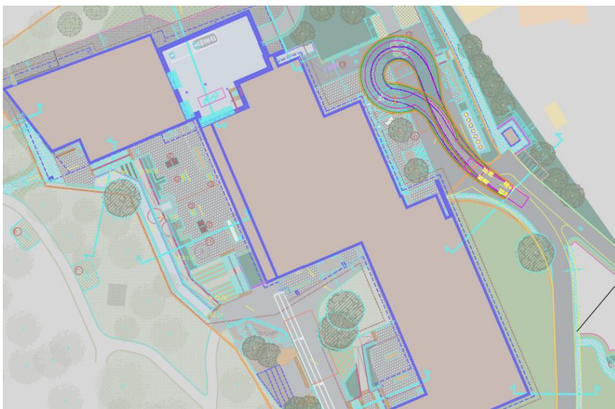
Figur 4: Illustrasjon som viser sporskurver for store kjøretøy med lengde på inntil 10,5m.
