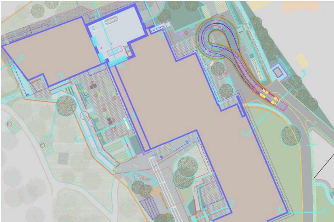
Figur 15 Sporing alt. C, lastebil 10,5 m
