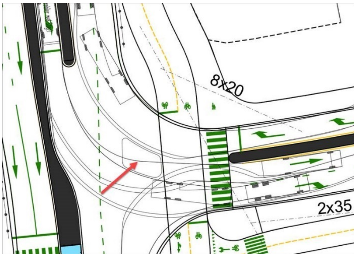
Figur 18 Svingebevegelser Fjøsangerveien x Fabrikkgaten viser en mulig refuge mellom E39 og sykkelvegen.
