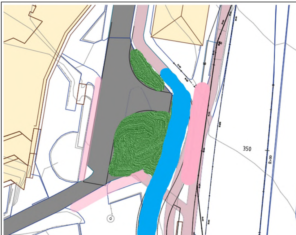
Figur 11: Utbedret busslomme og snuhammer
