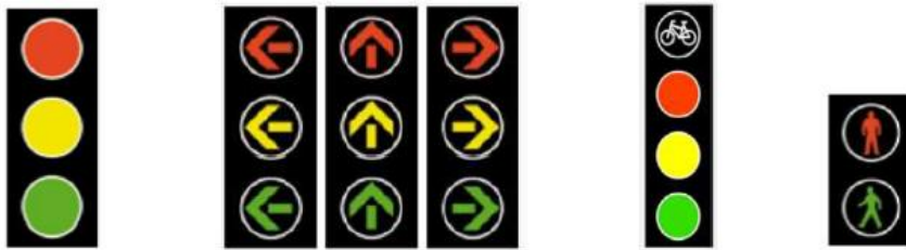
Figur 17: Signaler fra venstre: 1080 (hovedsignal), 1082 (pilsignal venstre, rett frem og høyre), 1084 sykkelsignal, 1086 (fotgjengersignal), jf. SVVs håndbok N303 Trafikksignaler.
