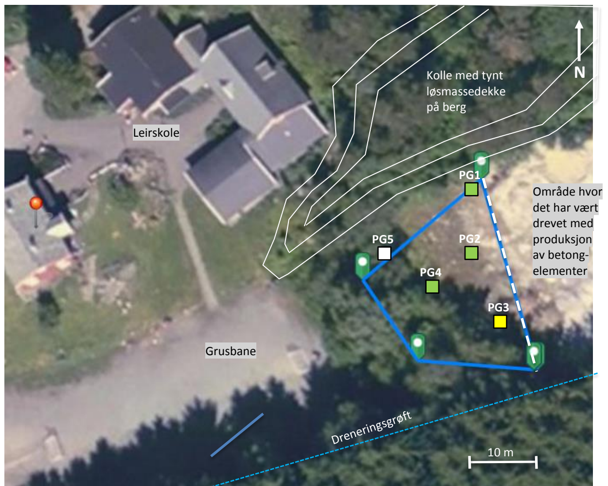
Figur 5.1: Flyfoto med omtrentlig plassering av prøvegroperne (PG1–PG5) i undersøkelsesområdet (avgrenset med blå streker). Flyfoto er fra 2005 da det da var mindre skog i området, samt at bildet viser hvor det i undersøkelsesområdet (i nordøstre del) ser ut til å ha pågått aktiviteter knyttet til driften på naboeiendommen i øst. Hvite streker nord for undersøkelsesområdet viser omtrentlig høydekontene (1 m) på kollen som ligger her. Eiendomsgrensen mot øst er vist med hvit, stiplet linje. Fargekoden på prøvegroperne viser høyeste tilstandsklasse (se figur 5.2) påvist for alle de analyserte stoffene, uavhengig av dybden prøven er tatt fra. I PG5 er det ikke sendt prøver til kjemiske analyser. Foto: www.norgebilder.no .
