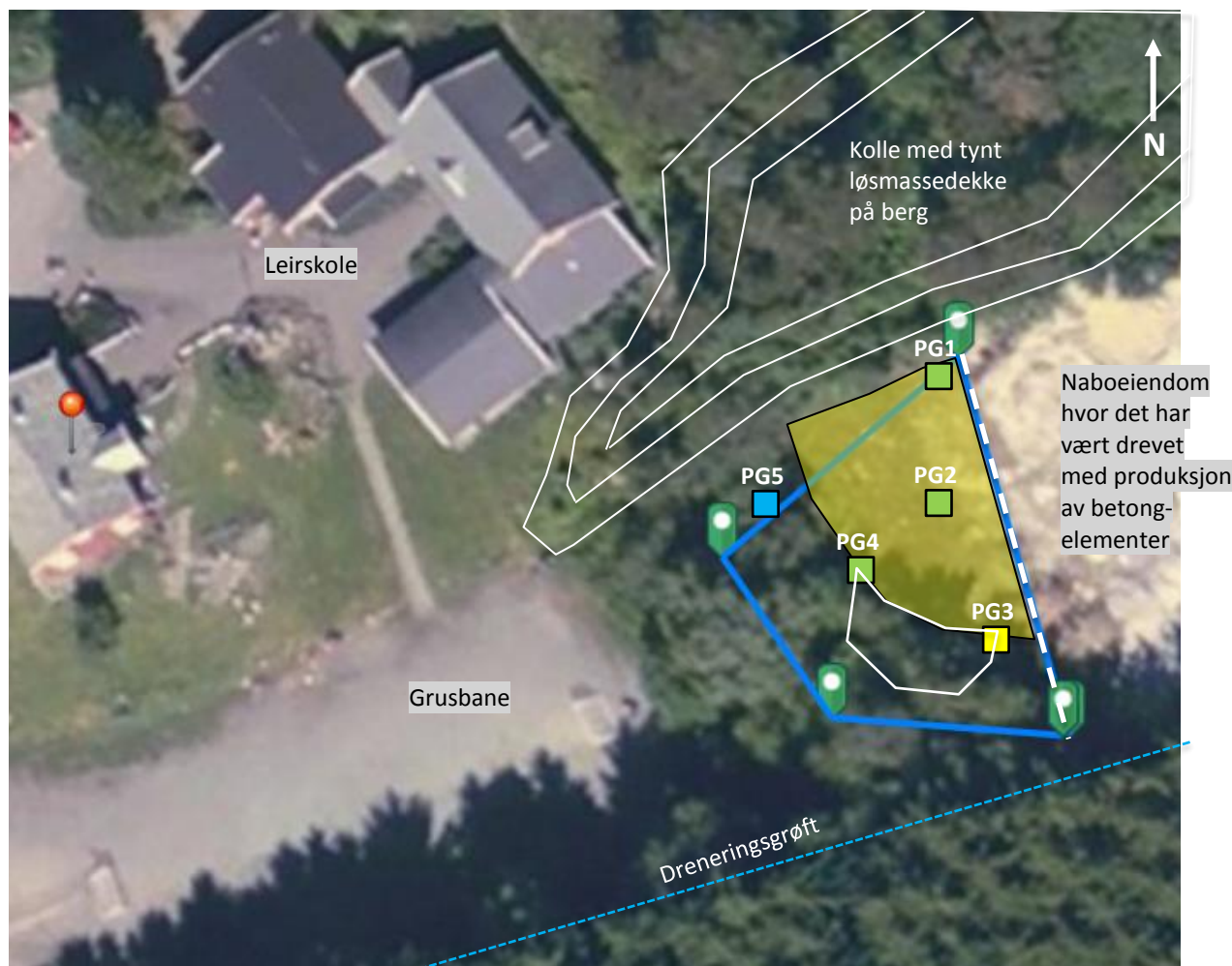
Figur 8.1: Tiltaksplan. Gulskravert område = Antatt avgrensning av området hvor det er fylt ut med fyllmasser med betong og armering. Det må tas supplerende prøver av de dypereliggende, antatt stedlige torvmassene som ligger under fyllmassene, for å dokumentere at de stedlige massene er rene. Hvite linjer mellom PG3 og PG4 = Område som må undersøkes for dokumentere at massene er kjemisk rene. Foto: www.norgebilder.no .
