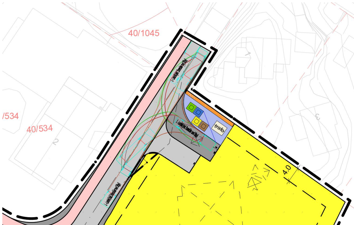
Figur 12: Sammenstilling av sporingskurver for inn- og utkjøring i planområdet fra sør (over kv.4577 Hjortevegen og o_KV) med utkjøring mot nord (over o_KV og kv.4398 Dyrhaugen) og fra nord (over kv.4398 Dyrhaugen og o_KV) med utkjøring mot sør (over o_KV og kv. 4577 Hjortevegen).
