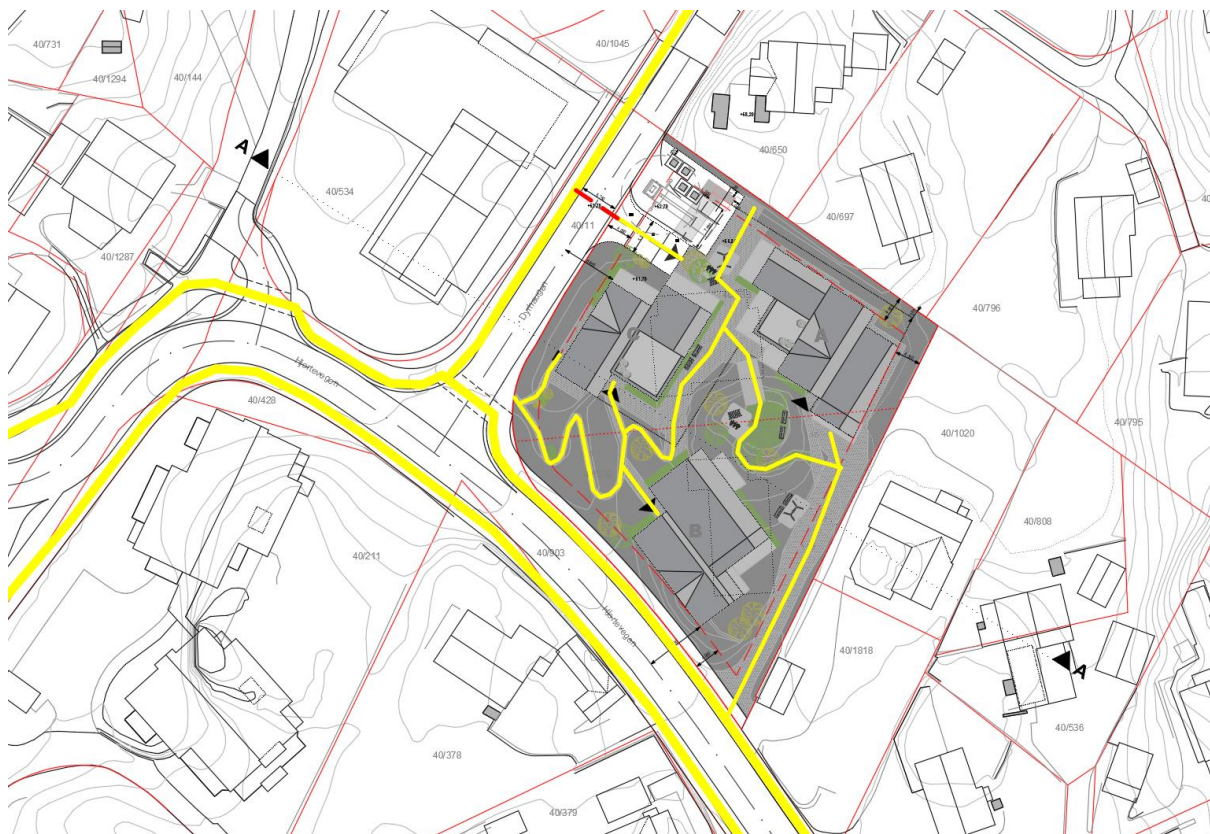
Figur 18: Trafikksikkerhetsanalyse: ferdselsårer er synliggjort med gule linjer og områder der sporingskurver krysser ferdselsårer er synliggjort med stiplet rød linje.
