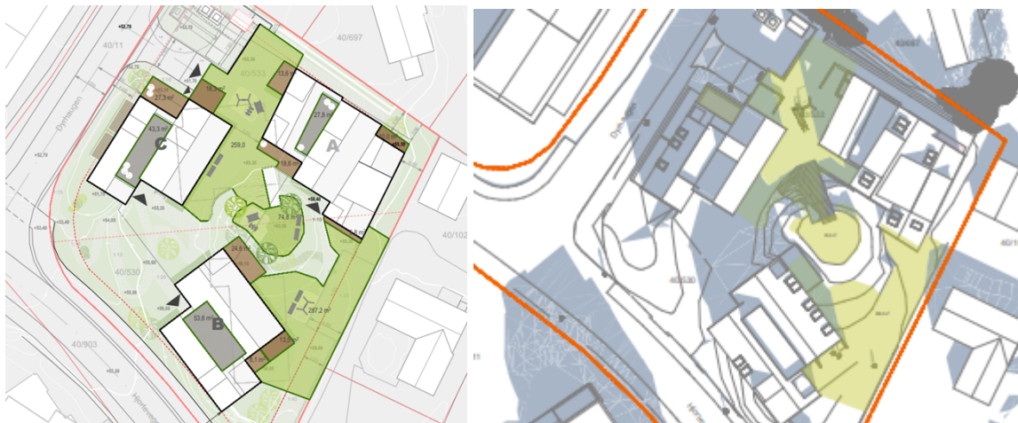
Figur 6: Til venstre viser mørkegrønt areal minimums uteoppfallsareal, og til venstre viser solbelagt uteoppfallsareal.
