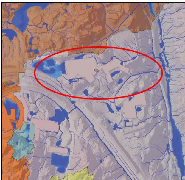
Figur 4 Modellering av overvann. Kilde: Scalgo Live
