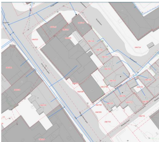
Figur 14 Til venstre vannledninger i planområdet (kilde: bergenskart.no) Til høyre: Eksisterende VA-anlegg i eksisterende bygg (kilde: VA-rammeplan datert 19.08.2022)
