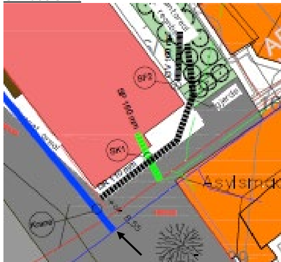
Figur 3. Tilknytningspunkt Vann. Vannforsyning
