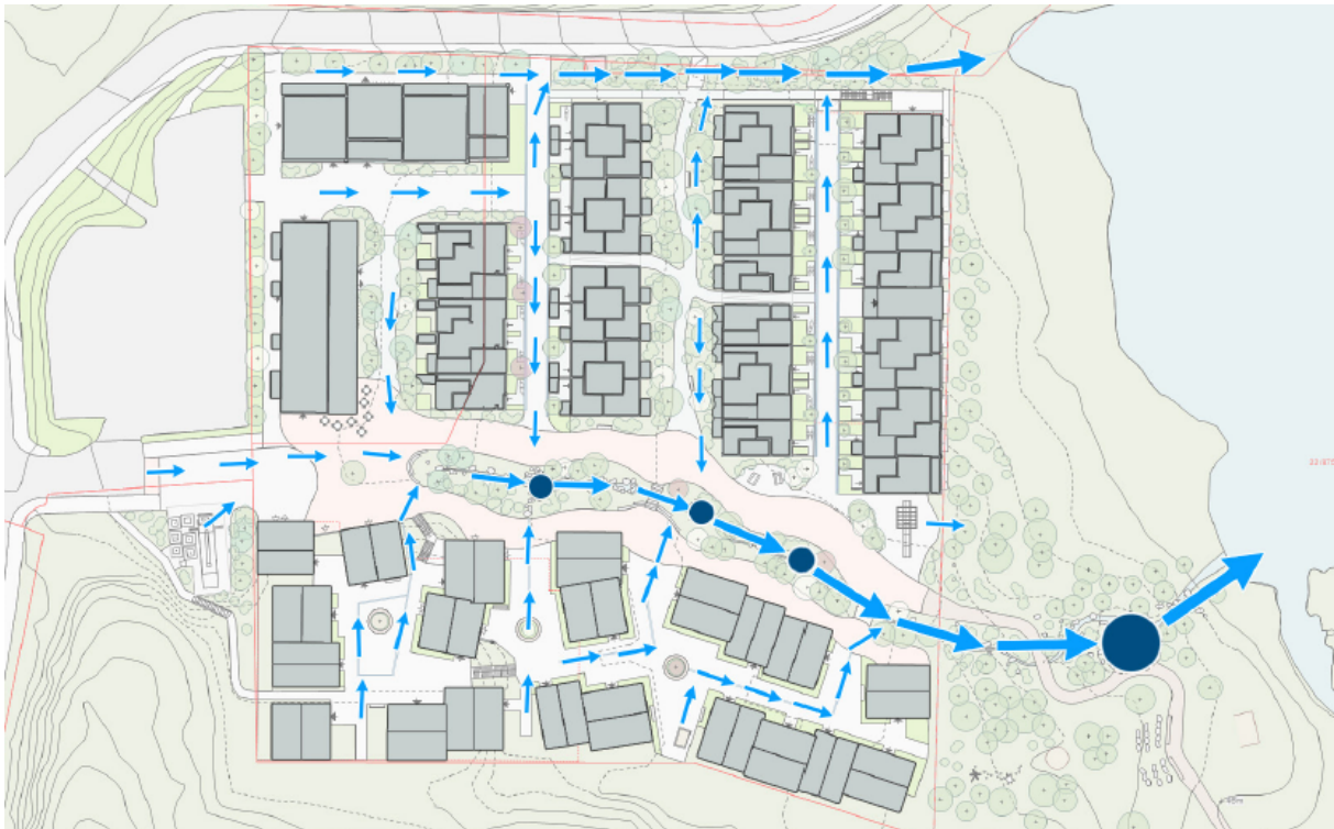
Figur 38 – Overvannshåndtering føres i åpne løp uten infiltrasjon i grunnen, frem til tjernet.
