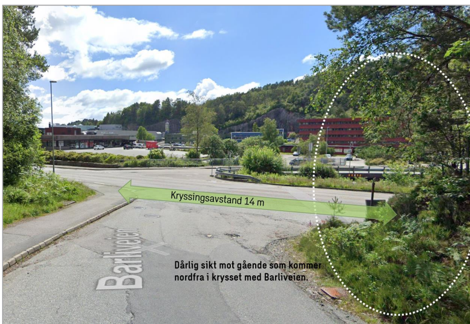
Figur 14: Redusert sikt mot gående som kommer nordfra Spelhaugen, samt lang kryssingsavstand for gående i krysset med Barliveien (Foto: google.maps.no).
