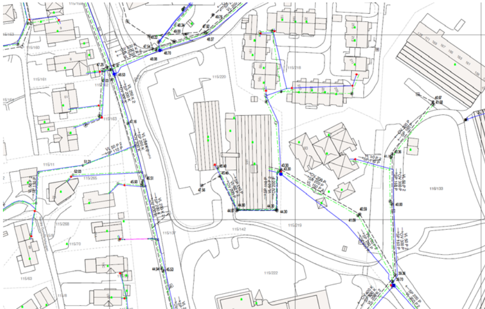
Figur 2 - Eksisterende ledningsnett for Sandslimarka 185
