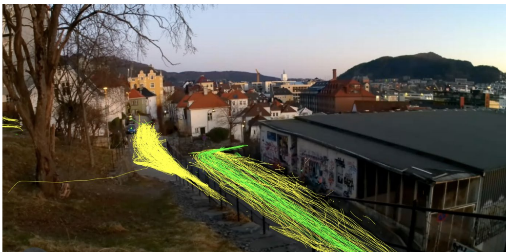
Figur 7. Utklipp fra Goodvision-analyse av trafikkstrømmene i forbindelse med arrangement (Aurora-konsert, mars 2024). Gående er vist med gule streker, kjøretøy med grønne streker.
