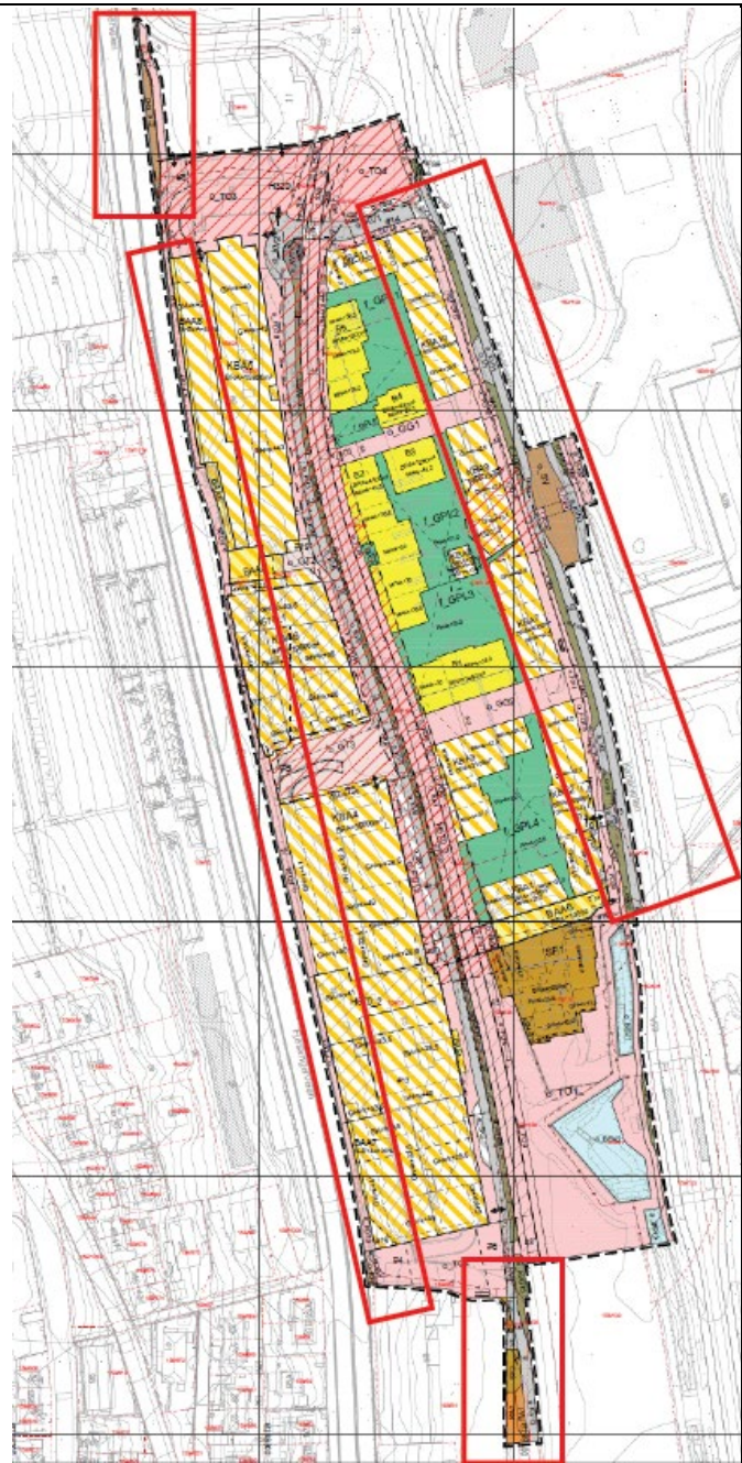
2-2 Plankartet til begrenset høring 2025. Røde rammer viser utvidelser av planområdet. Det er gjort endringer med bussholdeplass i nord, utviding av fortau langs Fjøsangerveien, forbedring av vareleveringslommer og gangkryssing over bybanen i Kanalveien og etablering av areal for renovasjon i sør.
