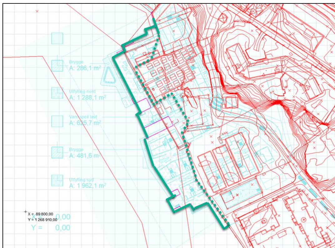
Figur 2. Oversikt over fyllingslinje. Areal for utfylling i sjø opp til kote minus 1,5 uten fyllingsfot er markert med grønn linje. Stiplet linje er bakre begrensning. Figur er hentet fra Multiconsult 2023.
