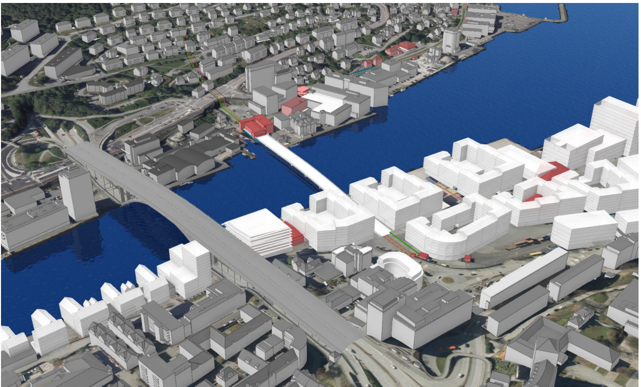
Figur 2-5: Illustrasjon av broalternativ B med seilingshøyde 4,5m over høyeste astronomiske tidevann. Broen har en totallengde på ca. 200m. Illustrasjonen viser eksisterende bygg, og får ikke frem at noen rives som følge av tiltaket.
