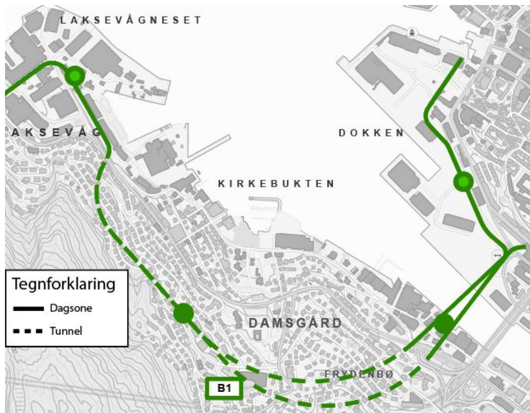
Figur 3-8 B1 med variant. NB: Plassering av holdeplasser er ikke avklart, markeringen symboliserer hvilke områder de grovt sett er tenkt plassert. Illustrasjonen viser også en mulig plassering av underjordisk holdeplass.
