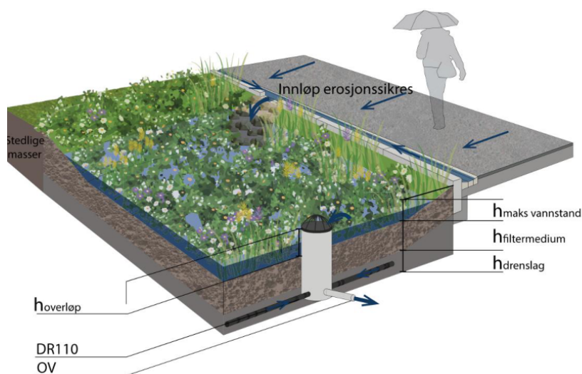
Figur 29: Prinsipp for åpent og grønt overvannstiltak med drenssystem inkludert overløp og drenssystem (Skisse: Structor Vann AS)
