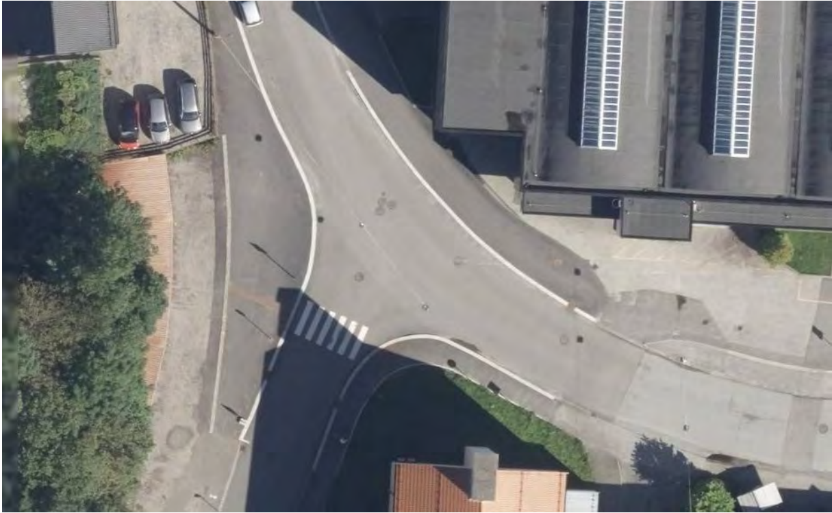
Figur 15: Eksempel på innsnevring i krysset ved Landås skole - Erleveien x Landåsveien.
