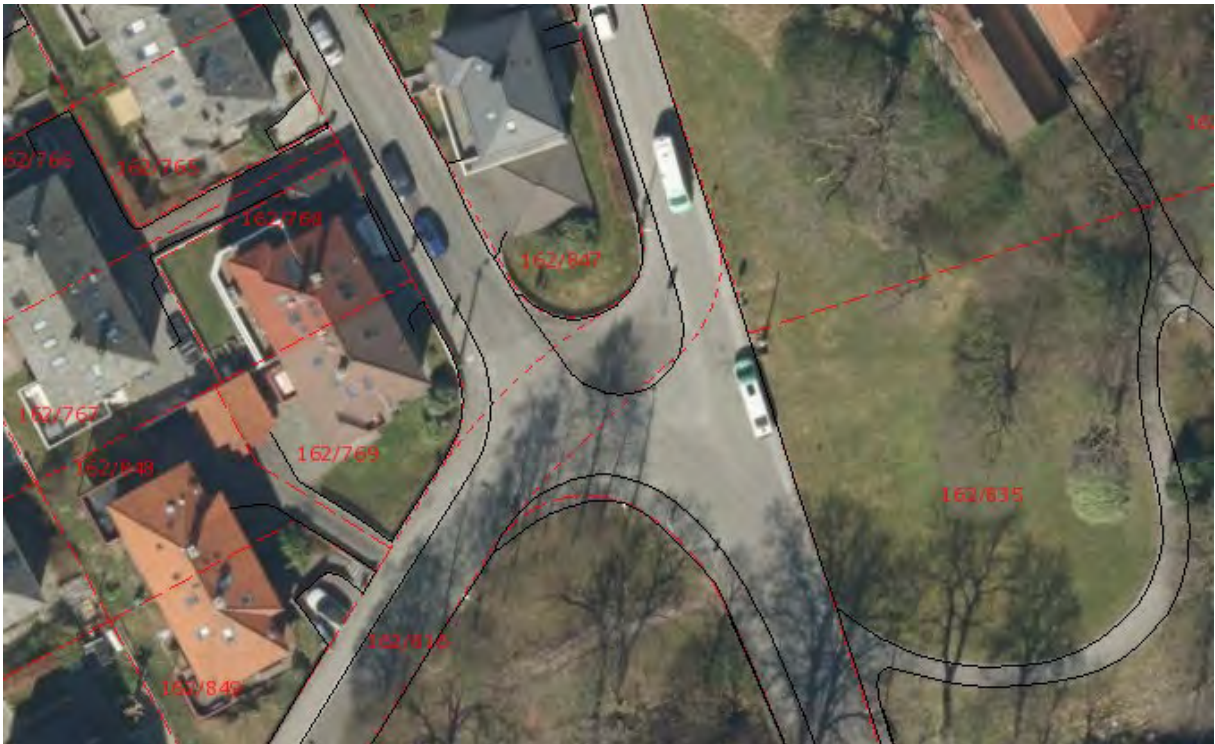
Figur 16: Sving/kryss Gimleveien x Idrettsveien som har blitt strammet opp.
