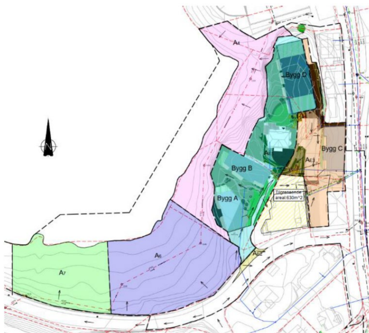
Figur 52 Utklipp fra VAO-rammeplan (fig. 5), overvannssoner og fall/avrenning.
