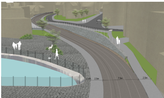
Figur 3-9 Skissert løsning for dagalternativene ved Tørrdokken. Her er må terrenget endres og byggene som er vist med rødt i illustrasjonen til høyre rives.
