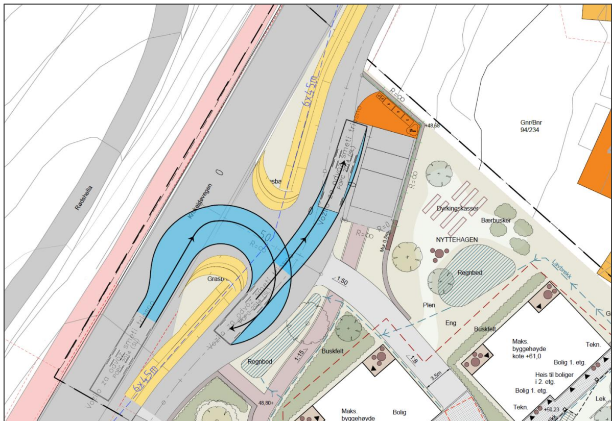
Figur 5.10.2 – Sporing for renovasjonsbil ved innkjøring til planområdet fra sør og rygging inn til renovasjonspunkt
