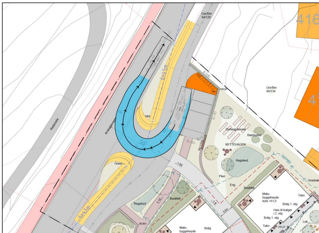
Figur 12 – Sporing ved utkjøring fra planområdet mot nord.
