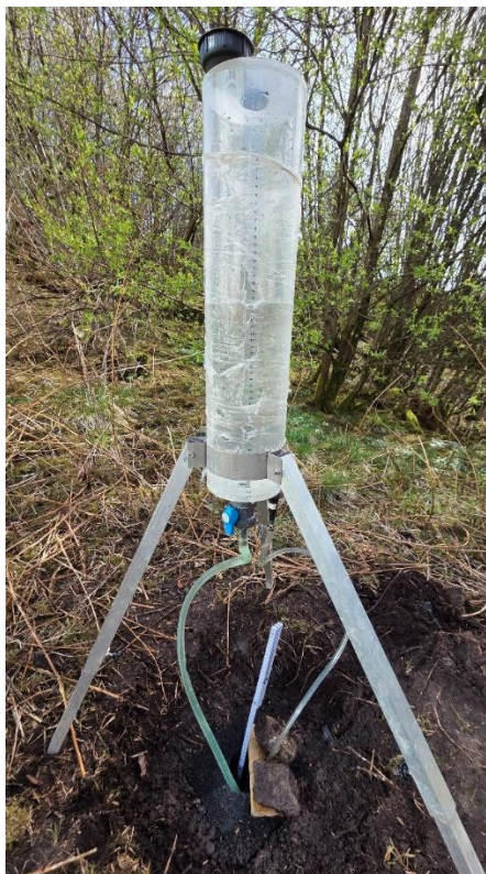
Figur 4 Skjematisk skisse av infiltrometeret til venstre og gjennomføring av infiltrasjonsmålingen til høyre.
