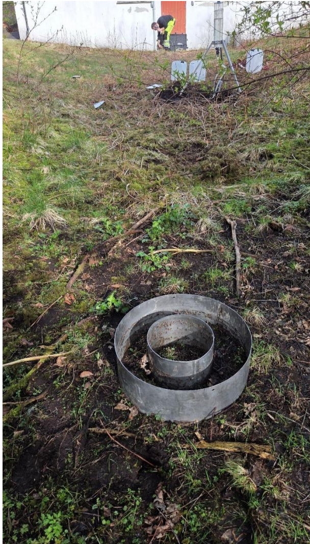
Figur 3 Dobbelt-ring-infiltrrometer benyttet ved målepunkt 2. Bilde til venstre er tatt mens infiltrasjonsforsøket pågår og bilde til høyre er før dobbelt-ring-infiltrrometeret er fylt med vann.
