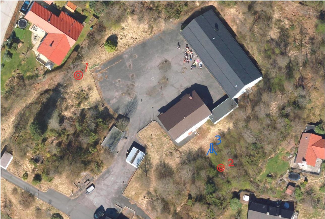
Figur 1 Viser kvar dei ulike forsøka vart gjennomført på tomte. Test nummer 3 ble gjennomført med klassisk infiltrrometer med svamp, test nr. 1 og 2 ble utført med dobbelt-ring-infiltrrometer.
