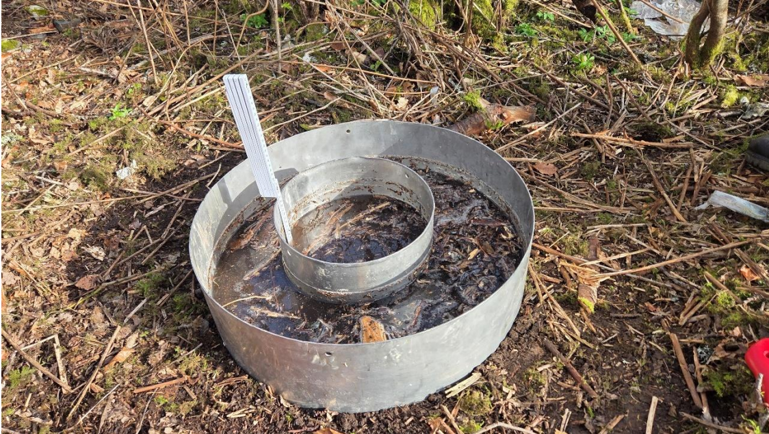
Figur 2 Gjennomføring av infiltrasjonsmåling nr. 1 ved hjelp av dobbeltringinfiltrrometer.
