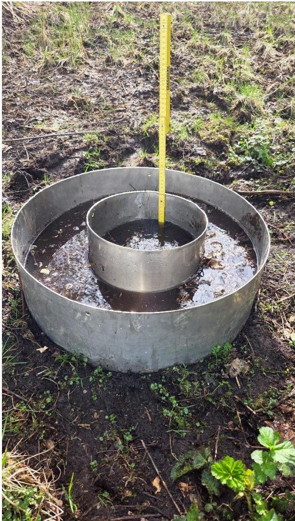
Figur 3 Dobbelt-ring-infiltrrometer benyttet ved målepunkt 2. Bilde til venstre er tatt mens infiltrasjonsforsøket pågår og bilde til høyre er før dobbelt-ring-infiltrrometeret er fylt med vann.
