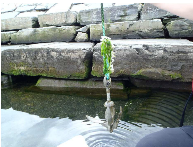
Figur 7 Innhenting av prøvetaker O1 ved utløp av overvann øst. Før fjerning av begroing.
