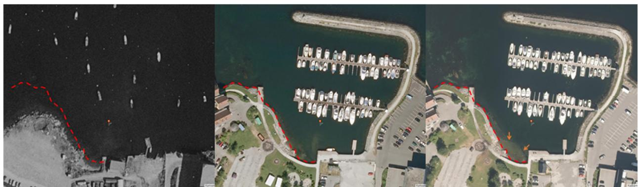
Figur 4: Historiske bilder hentet fra norgebilder.no. Til venstre: Kirkebukten 1980. I midten: Kirkebukten 2005, etter etablering av bydelspark og før tiltak i sjø. Til høyre: Kirkebukten 2016, etter tiltak. Rød stiplet linje viser kaifronten og strandsonen som eksisterer i dag. Oransje piler viser utfylt strandsone, avgrenset av betongmadrasser og blokker i front.
