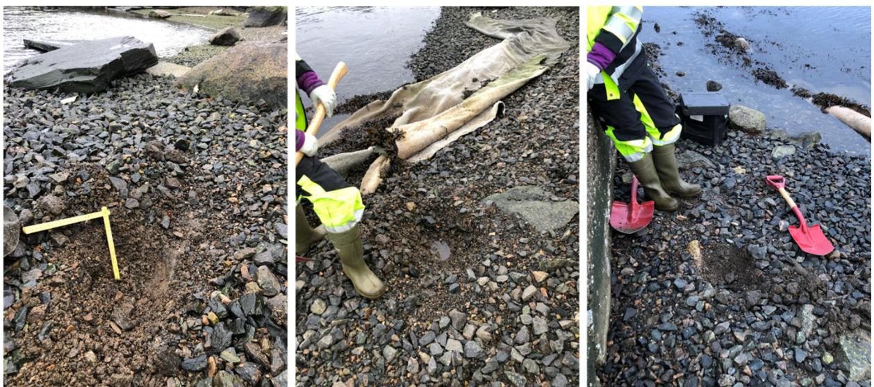
Figur 19: Til venstre, prøvegrop til KB3. I midten, grop uten nok finstoff til prøve. Til høyre, prøvegrop til KB2.
