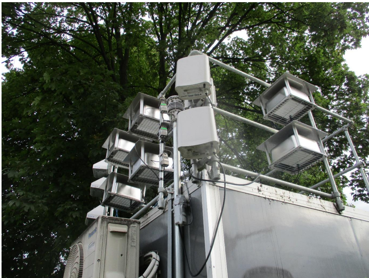
Figur 5.1 iFLINK-mikrosensorene ble samlokalisert med målestasjonen på Danmarks plass for kalibrering. Foto: Bergen kommune – Arild Jensen
