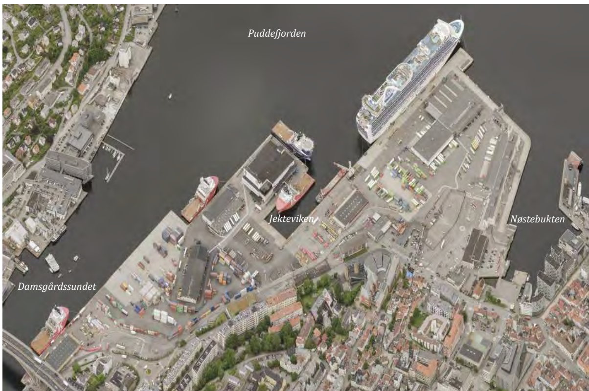
Figur 30: Dagens havneanlegg med containerhavn på Dokkeskjærskaien og i Jekteviken er anlagt på omfattende utfyllinger i Puddefjorden og Nøstebukten. Skråfoto fra 2017 (Kilde: Utsnitt fra http://www.blomwebviewer.com/map.html ).
